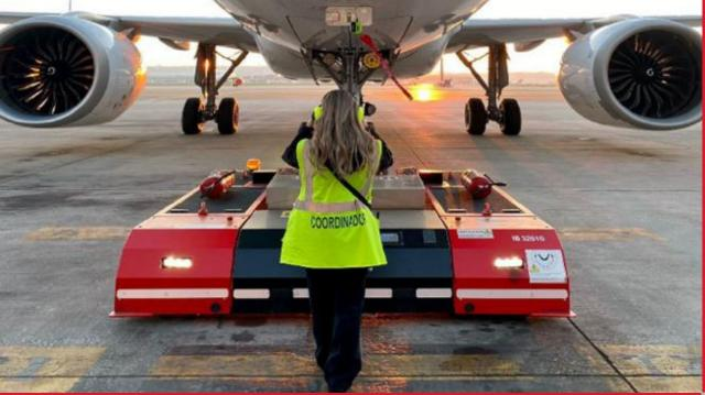
**Iberia Airport Services** ha implementado tecnología de push back eléctrico manejado por control remoto para remolcado de avión de la flota A220/A319/A320/A321 y B737.
